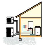
Integrazione idraulica con caldaia
